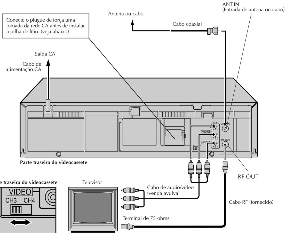
Certifique-se de conectar o plugue de força a uma tomada da rede elétrica primeiro, antes de instalar a pilha de lítio; do contrário, a vida útil da pilha será drasticamente encurtada.
